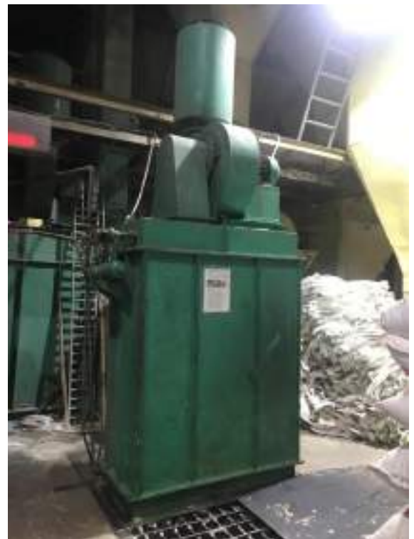
Hình 7: Hệ thống xử lý bụi khu vực nạp liệu
